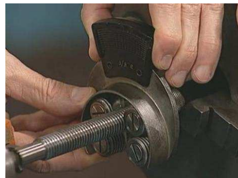
Calibração da rosca do parafuso com o calibrador passa-não-passa.
