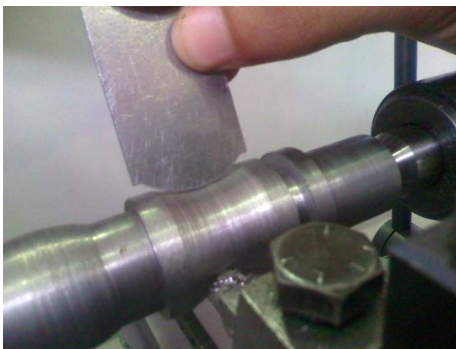
Verificação com gabarito de raio
