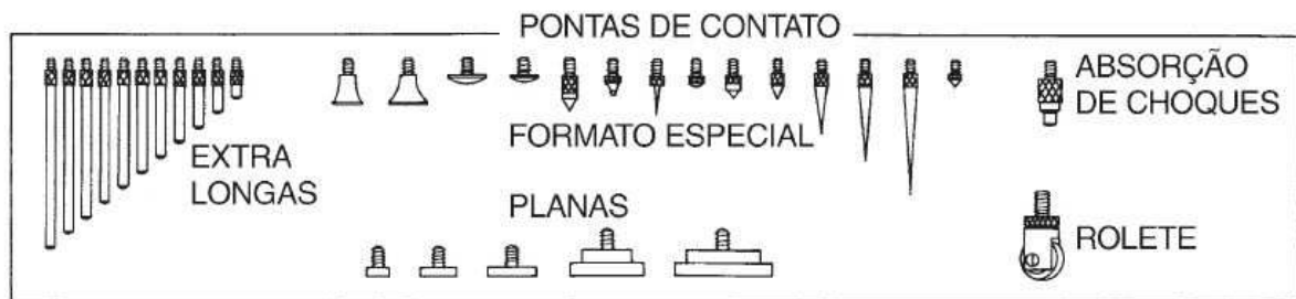
Fig.2 – Pontas de contato. Fonte: Manual do estudante – www.starrettonline.com
