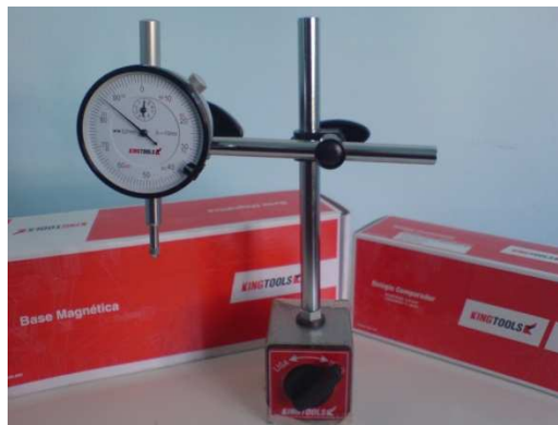
Fig.4 – Relógio comparador com base magnética. Fonte: http://images.quebarato.com.br/photos/big/B/2/56A9B2_1.jpg
