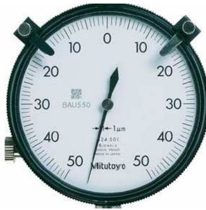
Fig.3 – Visor do relógio comparador com 0,01mm, cada divisão. Fonte: www.mitutoyo.com.br
