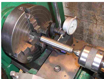
Fig.5 – Centralização de peça em torno
