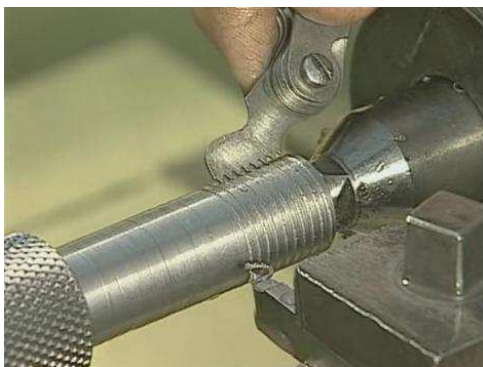
Verificação do passo da rosca com o pente de rosca
